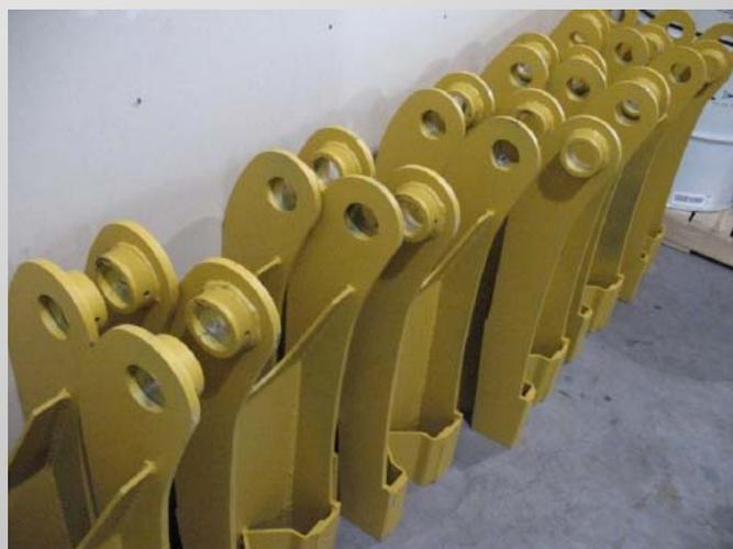
· 解決方法：LINE-X XS-100 噴塗在汽缸上，以保護撞錘及汽缸不受損壞。且在一個小時內即可噴塗完每個氣缸零件。
