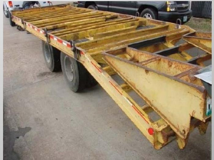
· 解決方法：LINE-X XS-100黃色，用於翻新和保護設備免受腐蝕和磨損。為了改善外觀並提供增強的紫外線穩定性，LINE-X XTRA添加了顏色來匹配，以滿足實際顏色規格。
