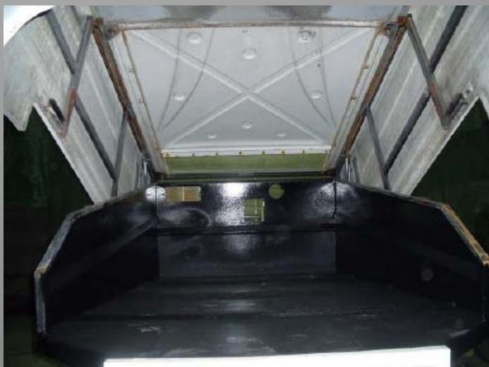
右圖：噴塗完 Line-X XS-100 的洗冰車廂內
