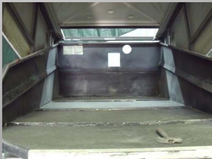
右圖：未噴塗 Line-X XS-100 的洗冰車廂做準備
